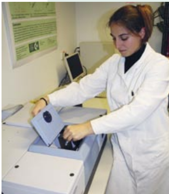
Mittels Infrarotspektrometer kann der Gehalt an Huminsäuren rasch quantifiziert werden. Avec l'aide de la spectroscopie infrarouge, les acides humiques peuvent désormais être rapidement quantifiés.
